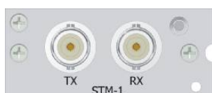
Obrázek 9 Modul STM-1 BNC
