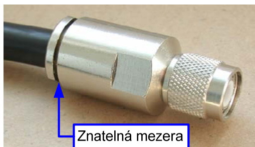
obr. 9: Dokončená montáž konektoru TNC
